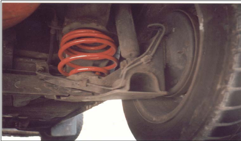
Das Bild zeigt die Hinterachse eines Opel Corsa A, an der ein Sonderfahrwerk verbaut wurde.
